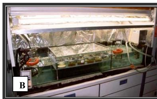
Obrázek 9 Kultivační zařízení testu s okřehkem L. minor ( A - pracoviště MBÚ AV ČR, Praha, ČR; B - pracoviště UFZ, Lipsko, Německo)
