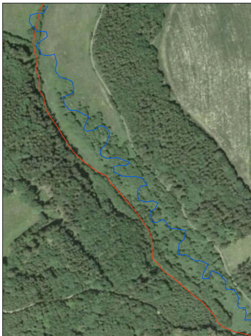
Obrázek 5: Úseky P08, P07 (0,5 až 1,5 říčního km). Znáznornění dnešní trasy koryta (červená linie) a původní trasy koryta (modrá linie), která byla odhadnuta pomocí zbytků původní vegetace, která je patrná i z leteckého snímku a po terénním průzkumu. Dnes je tok hodnocen 5.HMC (podle RHS). Současné koryto je výrazně napřímené, zahloubené a vedené při okraji nivy.
