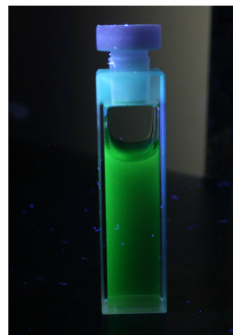
Obr. 42: Suspenze (20% zředění) LSMO@SiO 2 (F)@SiO 2 při (M595.10) v kyvetě při ozařování 366 nm UV světlem
