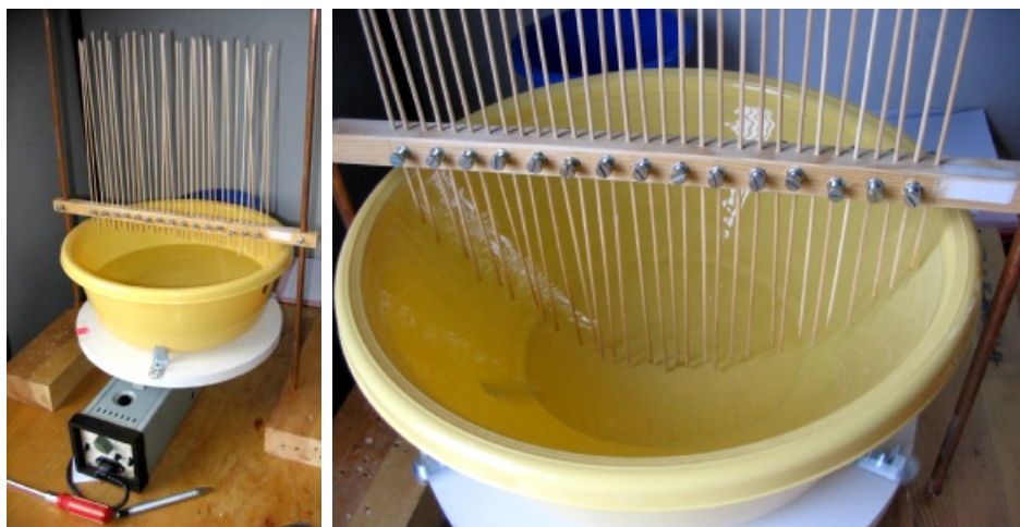
Obrázek 3.5: Provizorní zkušební zařízení pro měření tvaru kapaliny vyrobené autorem práce.
