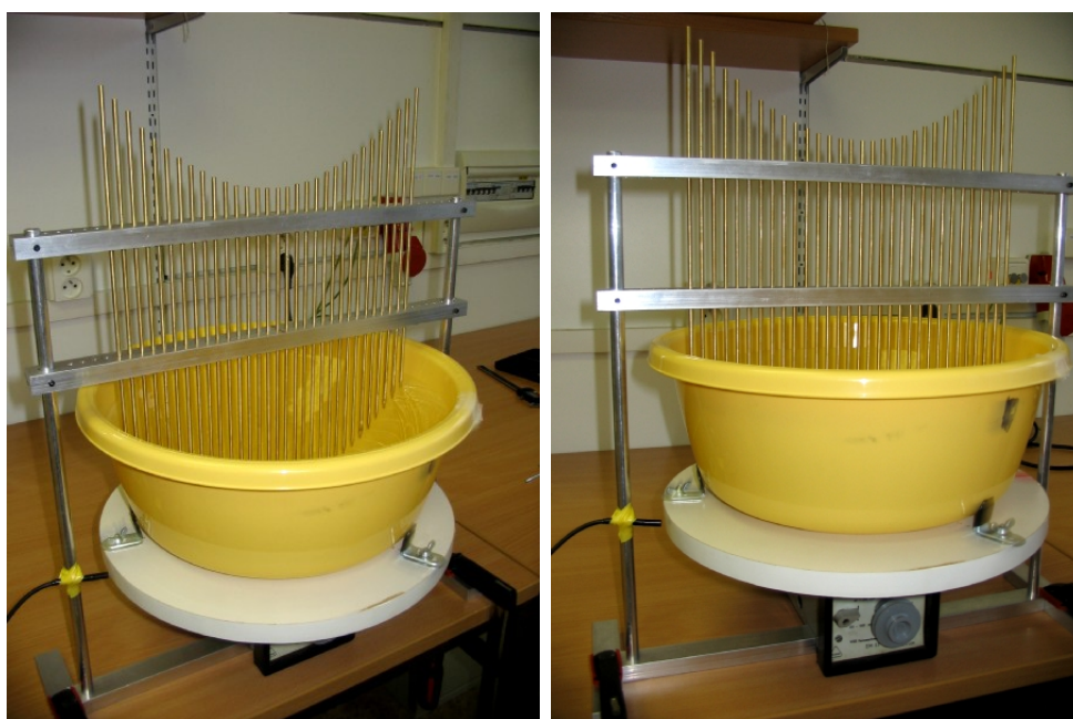
Obrázek 3.5: Provizorní zkušební zařízení pro měření tvaru kapaliny vyrobené autorem práce.
