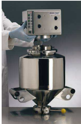
Obrázek 3.2.3.6. NIR analyzátor nasazený na homogenizačním zařízení.
