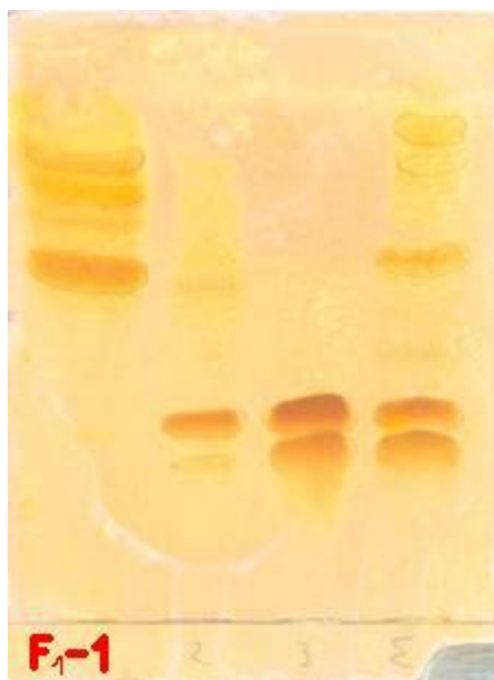
Obr. 10: Odparek F 1 - 1,2,3 a původní vzorek F 1 , soustava Benzen+Et 2 NH=9:1(Kieselgel UV 254 Merck, 10 cm (dráha 8,5 cm), detekce Dragendorffovým činidlem podle Muniera).
