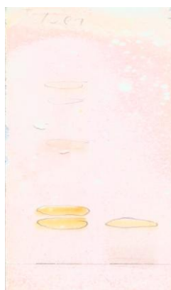
Obr. 9: Kontrolní vyvíjení F 1 a F 2 (F 1 - levá skvrna, F 2 - pravá skvrna) (Kieselgel UV 254 Merck, 10 cm (dráha 8,5 cm), Toluén+Et 2 NH-9:1, komora nasycená, vyvíjení 2×)
