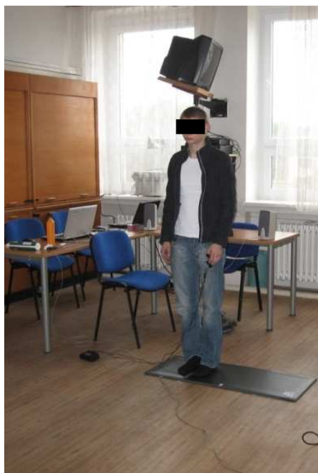
Obr. 22 Úzký stoj na stabilometrické desce během měření
