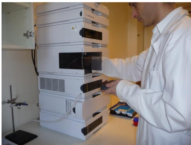
Obr. 28 Vložení vzorkovnic do analyzátoru (autorka 1.12.08)
