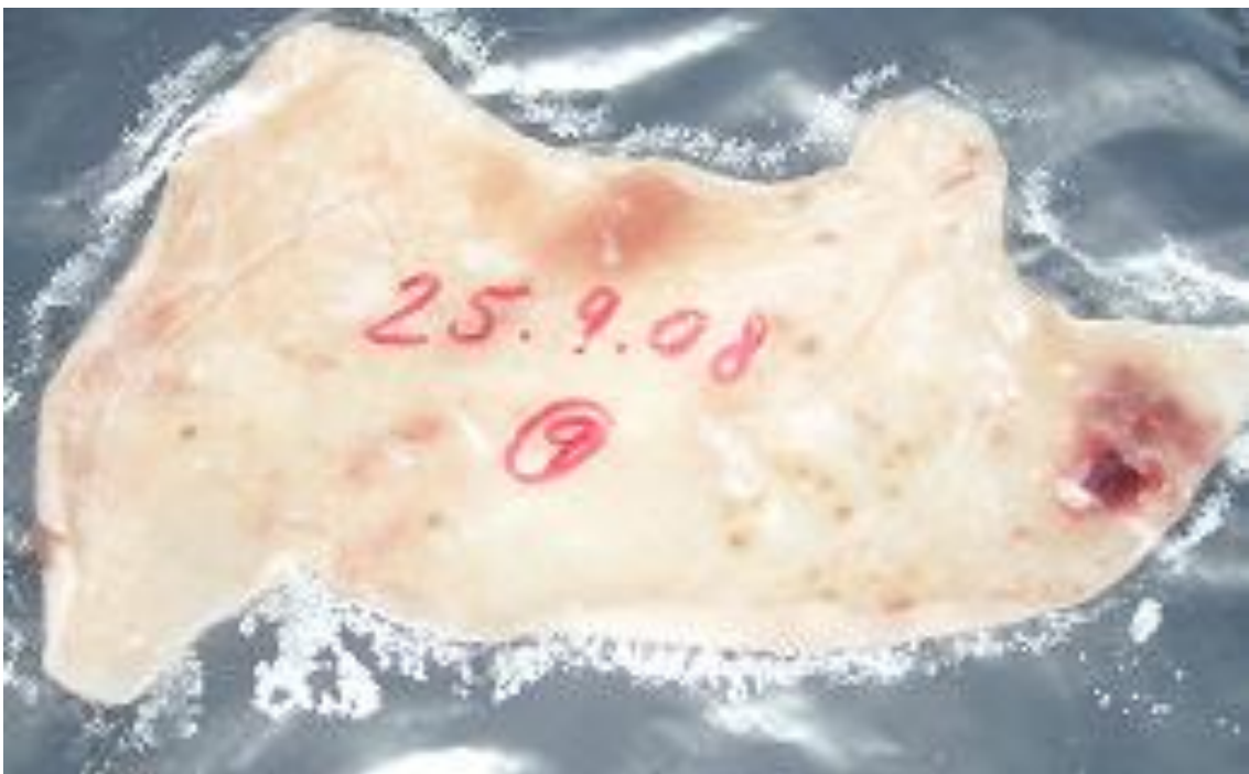
Obr. č.8.: Zmražená kůže z ušních boltců prasete používaná pro permeační pokusy
