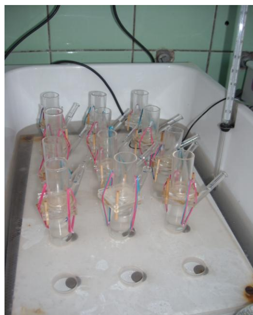
Obr.č.13: Sestavená Francova difúzní buňka Obr.č.14: Buňky umístěné ve vodní lázni
