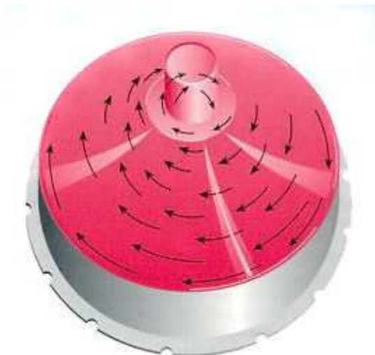
Obrázek 7 Schéma působení odstředivé síly na krev v čerpadle
