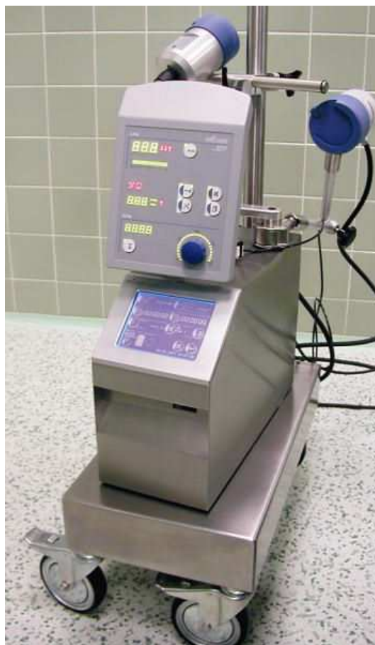
Obrázek 8 Centrifugální radiální čerpadlo (Stöckert Spin): pohonná a řídicí jednotka.
