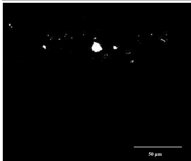
Obr. 2.6: Binární obraz částic rumělky odpovídajících rozsahu intenzit 255-250 ve vzorku M0501-4.
