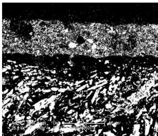
Obr. 2.9: Binární obraz částic rumělky, olovnaté běloby, hlinek a částic s vysokým obsahem uhlíkaté černi odpovídajících rozsahu intenzit 255-50 ve vzorku M0501-4.
