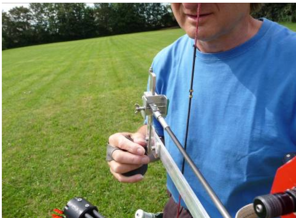
Obrázek 29 - Pro úpravu výškových rozptylů šípů v terči slouží šrouby vertikálních mířidel.
