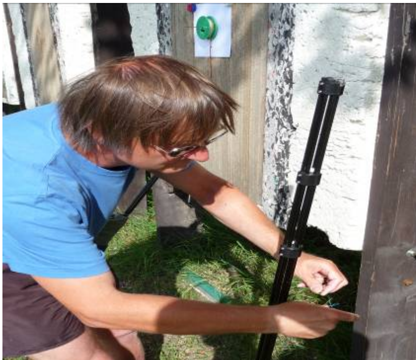
Obrázek 16 – Připevnění lanka na háček mířící tyčky zaměřovacího zařízení.
