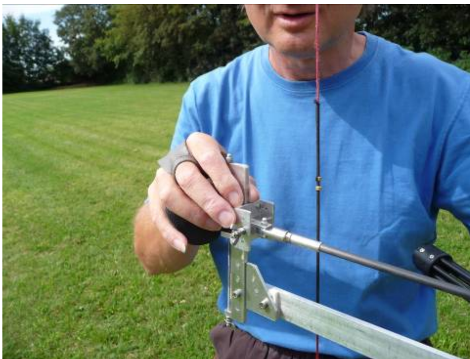
Obrázek 28 - Pro úpravu stranových rozptylů šípů v terči slouží šrouby horizontálních mířidel.
