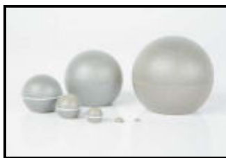
Obrázek 12: Pasivní markery ( www.qualisys.com ).
