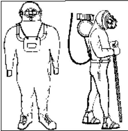
Obrázek 5 – a) Siebeho uzavřený oblek; b) "Aerophore"
