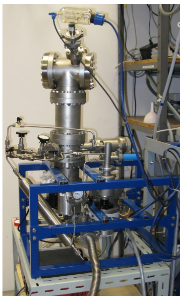
Obrázek 4.13: Celková fotografie generátoru para-vodíku. Jsou zde vidět ionizační a Piraniho vakuometry. Vyprodukovaný para-vodík lze uskladnit v láhvi s poteflonovanou vnitřní stěnou.
