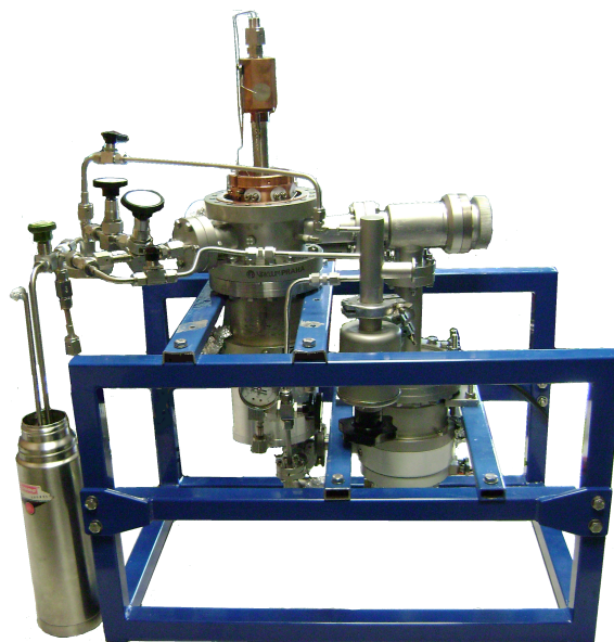
Obrázek 4.12: Fotografie generátoru para-vodíku: konverzní komora s chladicí hlavou a vakuový systém. Komora obklopující konvertor a kryt chladicí hlavy jsou pro účely fotografie odstraněny.
