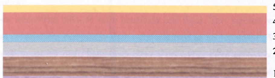
Obrázek č. 1. Schématický nákres barevné vrstvy. 1 – podložka, 2 – podkladová vrstva, 3 – izolace, 4 – barevná vrstva (směs pigmentu nebo barviva s pojivem), 5 – závěrečná ochranná vrstva (lak).
