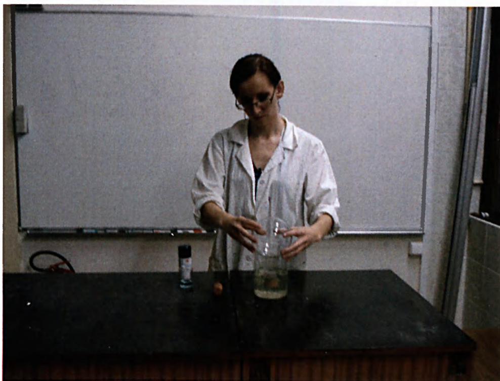
Upevnění baňky s amoniakem do baňky s roztokem vody s peroxidem a katalyzátorem
