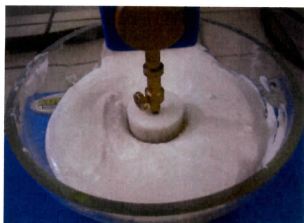
Obr. 22-24: Experimentální měření materiálových vlastností hmoty – závislost vhloubení na čase.
