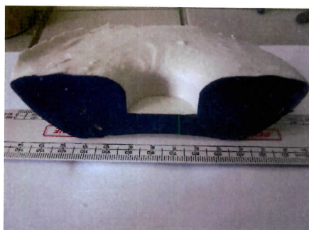
Obr. 22-24: Experimentální měření materiálových vlastností hmoty – závislost vhloubení na čase.
