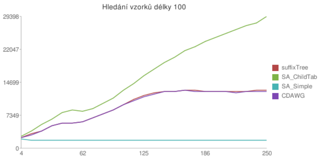
Obrázek 6.1: Závislost času hledání vzorků délky 100 znaků v závislosti na velikosti abecedy. Na ose x je vyznačen počet znaků abecedy a osa y udává čas vyhledávání v milisekundách.
