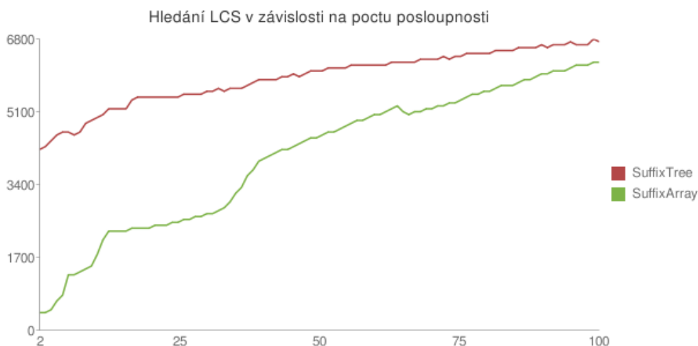
Obrázek 6.16: Závislost času hledání nejdelšího společného podslova slov v závislosti na počtu vstupních slov při abecedě o velikosti deset znaků. Na ose x je vyznačena velikost množiny slov a osa y udává čas hledání nejdelšího společného podslova všech slov množiny v milisekundách.
