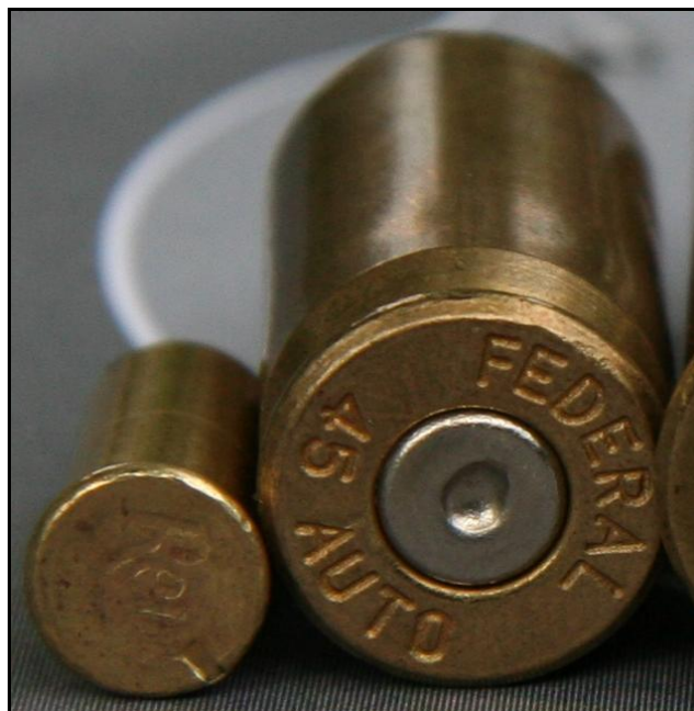
Vlevo zápalka okrajová, vpravo zápalka středová. Zdroj: A Catalog of What We Fired 3, www.flickr.com [online]. [cit. 2016-09-28]. Dostupné z: < https://www.flickr.com/photos/44705513@N00/1397923289 >
