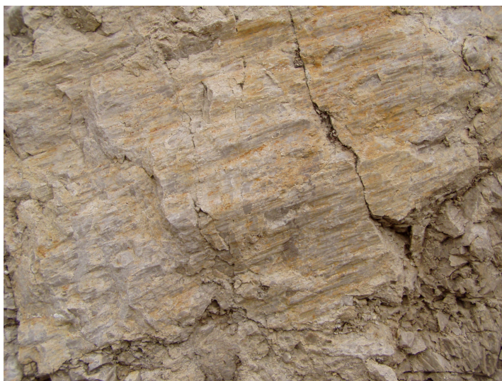
Obr. č. 25: Tektonické zrkadlo na poruche 220/45 so známkami po smernom pohybe. Pravostranný zmysel pohybu tu dokumentujú fraktúrne stupne, ryhovanie a prúdy.
