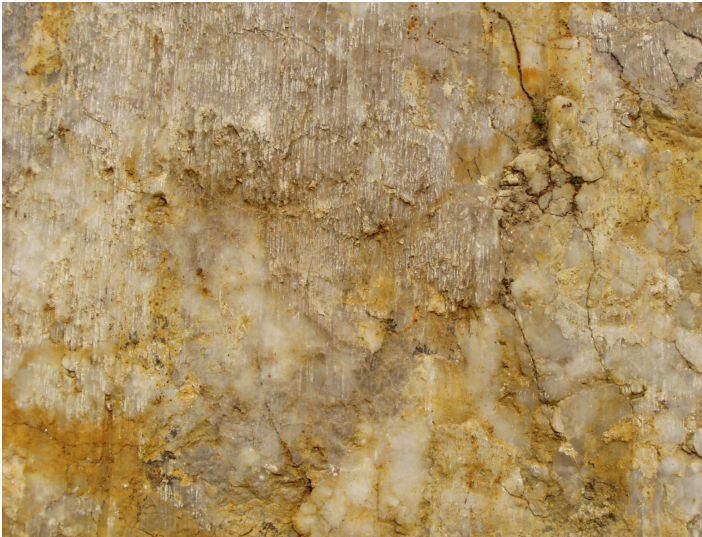
Obr. č. 14: Tektonické zrkadlo na ploche 195/88. Fraktúrne stupne a ryhovanie dokumentujú poklesy na zlome.
