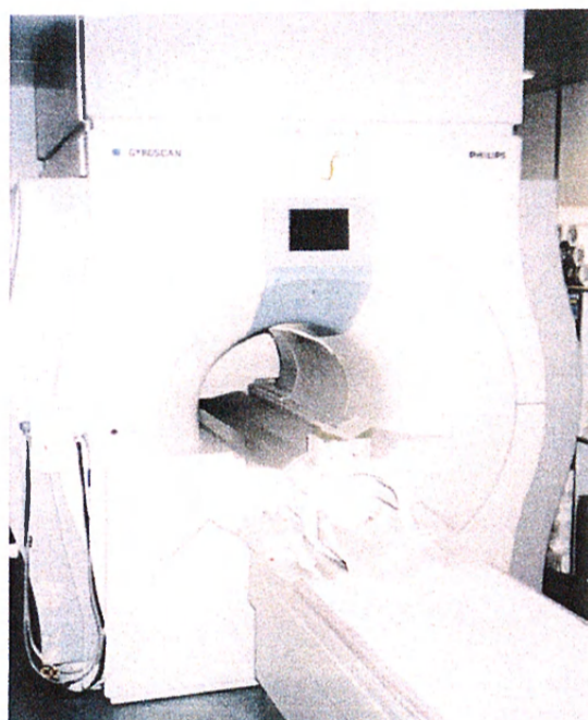
Obrázek č.6: přístroj magnetické rezonance Gyroscan 1,5 T firmy Philips.
