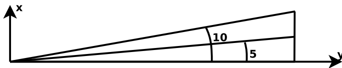
Obrázek 5.10: Příklad dvou trojúhelníků umožňujících parametrizovat modifikovaný Bresenhamův algoritmus na kreslení polopřímky úhlem, který polopřímka svírá s osou x.
