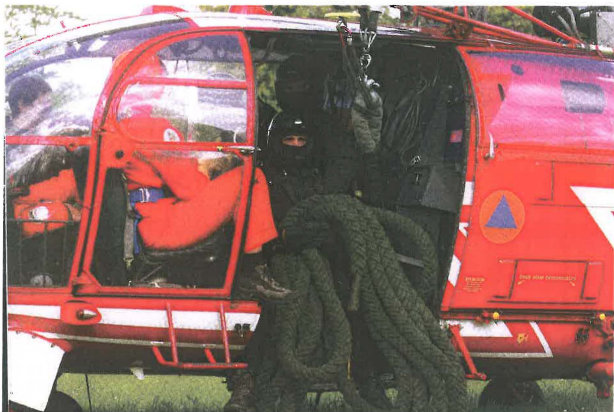
Obr. 21 Ukotvení rychlého lana ve vrtulníku (RAID-Francie, 2006)
