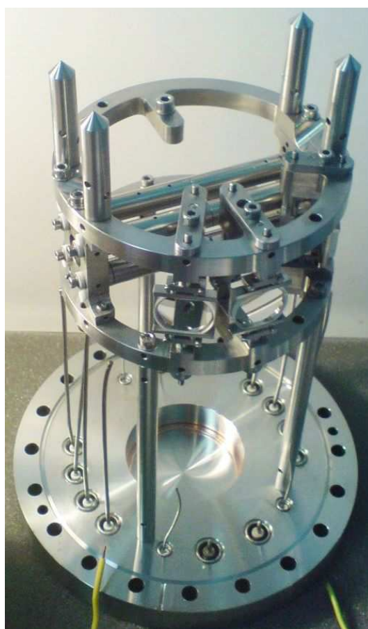
Obr. 4.4: Schématické znázornění a fyzické provedení kvadrupólů. Vlevo starší hyperbolický, vpravo nový tyčový.
