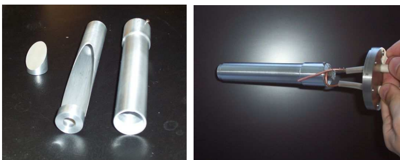
Obr. 6.6: Bezmřížkový Faradayův válec – rozložený (vlevo) a složený (vpravo).
