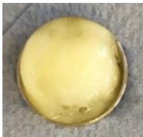
Obr. 15: Nabobtnalá směs MLX-HPMC 1-8 PM po disolučním testu
