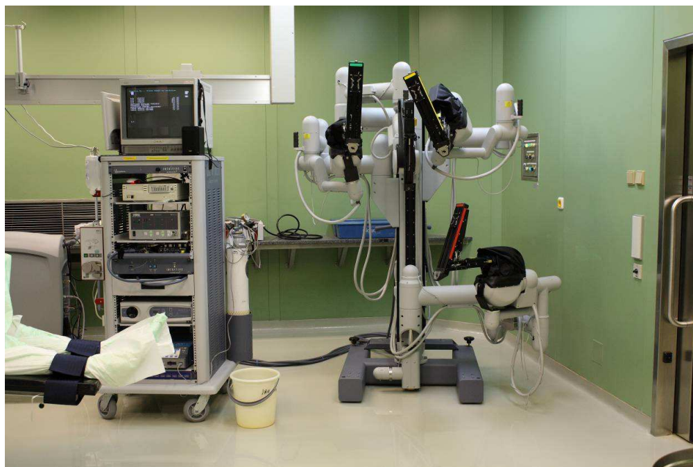
Obr. 2 Vlevo videověž, vpravo 4 ramenná chirurgická konzole
