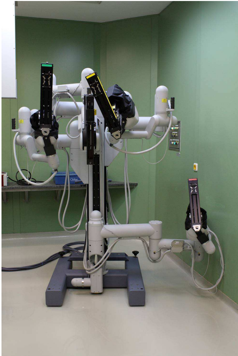
Obr. 9 Chirurgický systém da Vinci 1200 používaný v ÚVN. Barevně označená ramena jsou nástrojová. Bez označení je kamerové.
