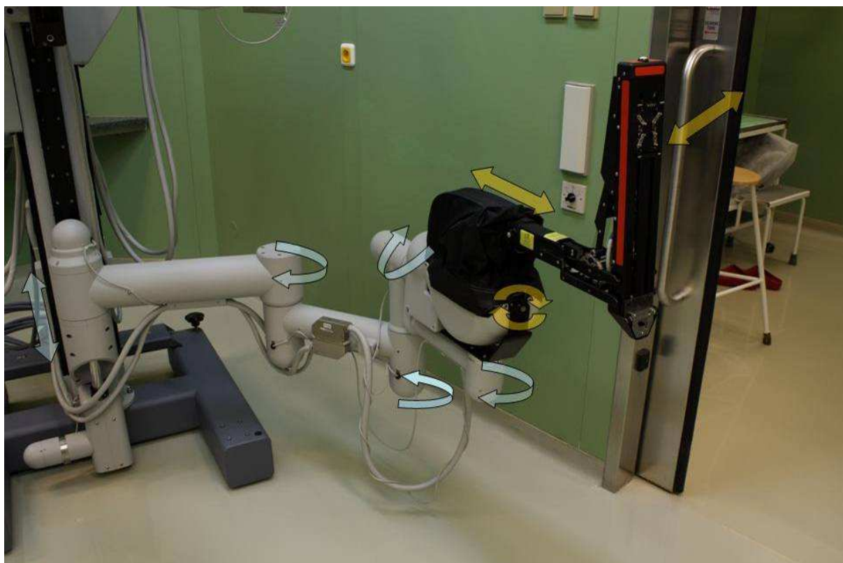
Obr. 12 Znárodnění možností pohybu robotického ramena. Modře brzděné pohyby, žlutě motorické.
