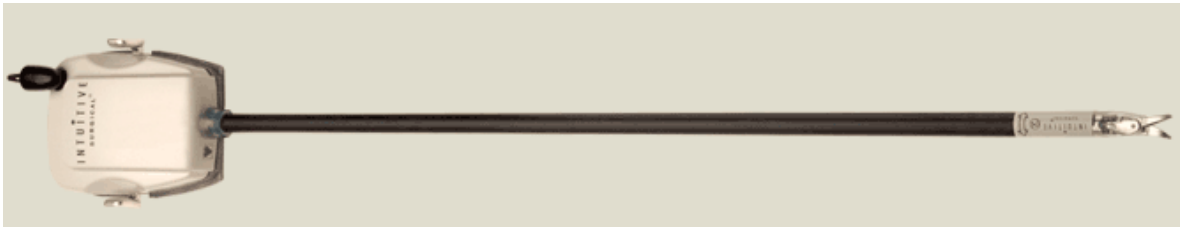
Obr. 15 Celkový pohled na robotický nástroj Vlevo základna, uprostřed tělo nástroje, na konci hrot.
