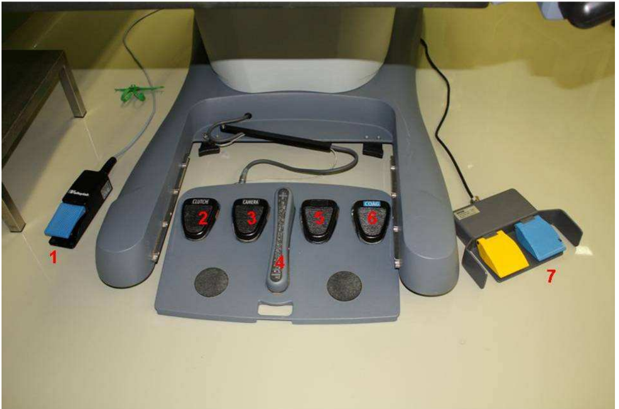
Obr. 8 Nožní ovládání – 1) externí ovládání bipolární koagulace 2) spojkový pedál 3) ovládání kamery 4) ostření kamery 5) u tohoto přístroje pedál bez funkce, u novějších verzí přímo ovládá bipolární koagulaci 6) monopolární koagulace 7) ovladač záznamového zařízení
