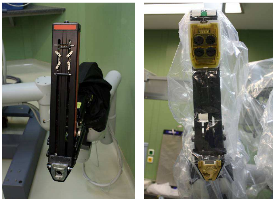
Obr. 11 Vlevo detail ramena a pozice pro umístění sterilního adaptéru. Vpravo sterilně pokryté rameno s připevněným sterilním adaptérem a držákem trokaru
