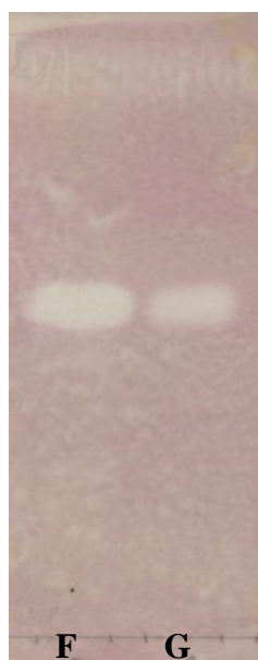
Obr. 3: Detekce standardů (fisostigminu a galanthaminu) bioautografickou metodou v neutrální vyvíjecí soustavě (S1)
