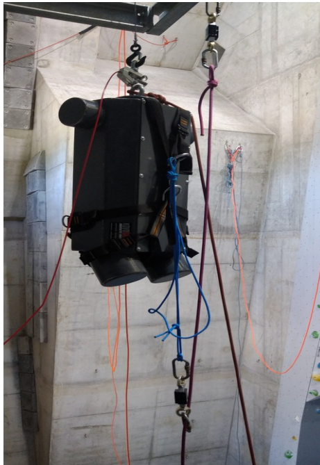
Obrázek 20 Pád improvizovaného ferratového setu do průvěsu z dynamického lana
