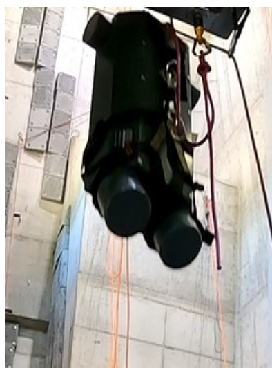
Obrázek 19 Testování vlivu dynamického lana na výslednou rázovou sílu
