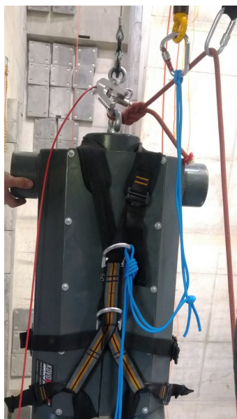
Obrázek 22 Testování improvizovaného ferratového setu při pádu z 0,5 m
