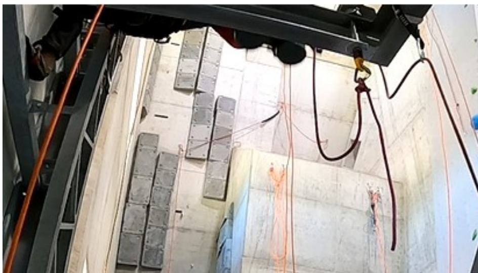
Obrázek 24 Průvěs z dynamického lana o velikosti 1 m
