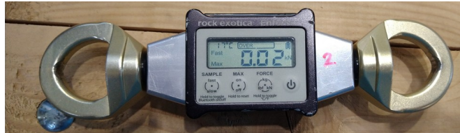
Obrázek 21 Zařízení pro měření výsledné rázové síly
