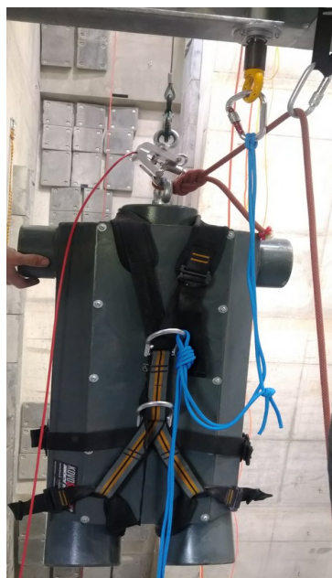
Obrázek 18 Testování improvizovaného ferratového úvazku
