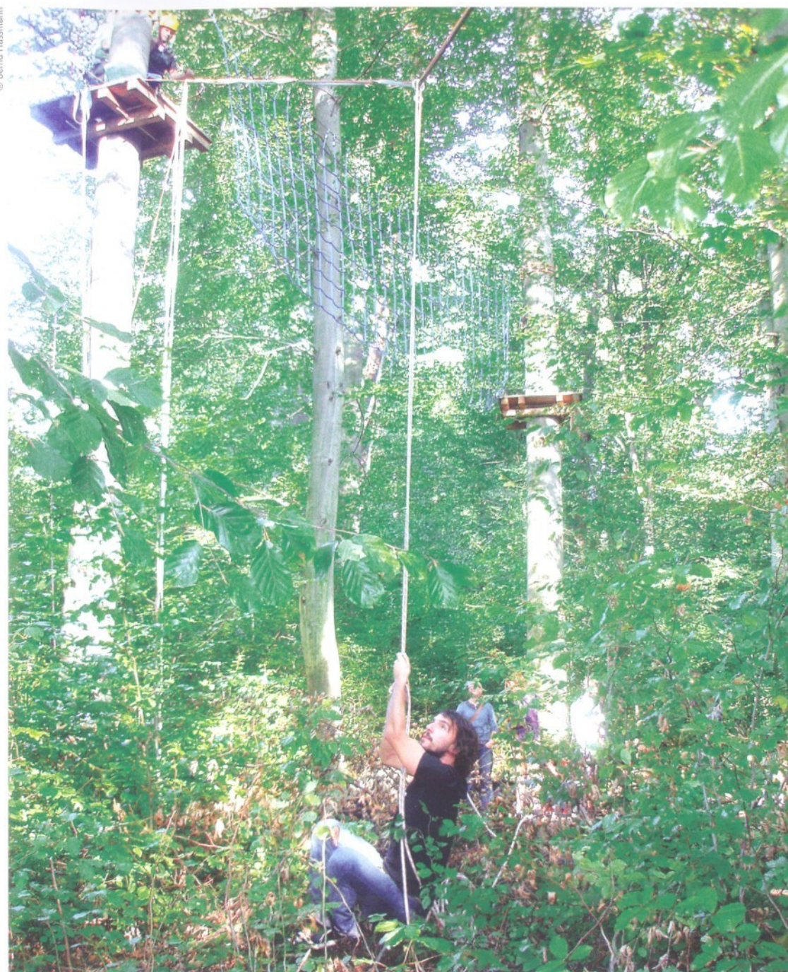
Wird nur das Redundanzseil belastet, kann es knapp werden mit dem Bodenabstand, wie man hier sieht.
