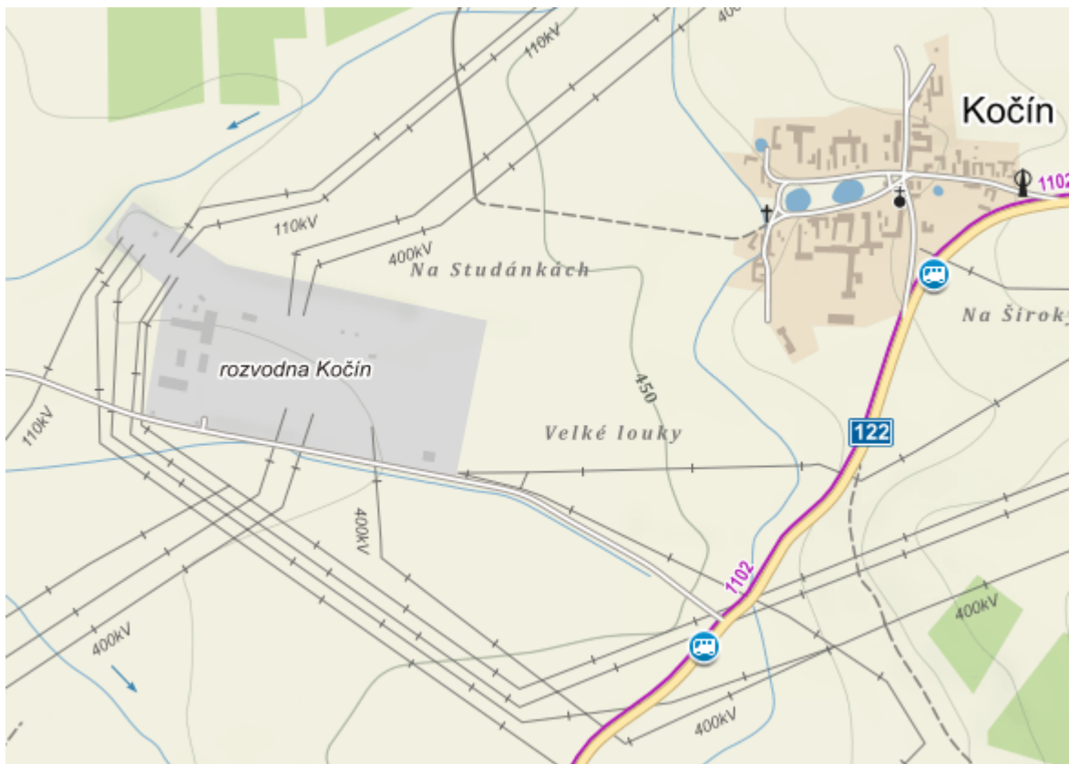
Obr. 18.: Tento výřez z turistické mapy dobře zobrazuje množství a trasy linek vysokého napětí vstupujících (sever) a vystupujících z rozvodny. Zároveň zde můžeme porovnat rozlohu rozvodny s rozlohou samotné obce Kočín.
