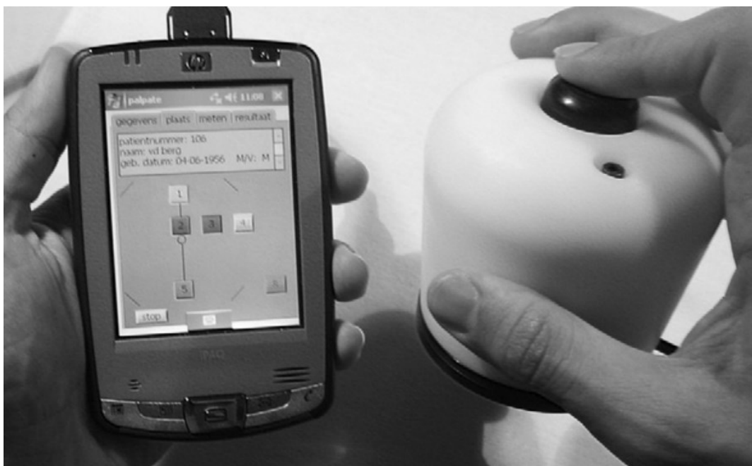
Obrázek 8: Přístroj na měření napětí břišní stěny (Ramshorst et al., 2011)
