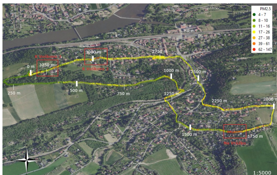
Obrázek 4.9: Průběh koncentrace PM_{2,5} v \mu\text{g} \cdot \text{m}^{-3} během procházky 3 s vyznačeným místem zvýšených koncentrací
