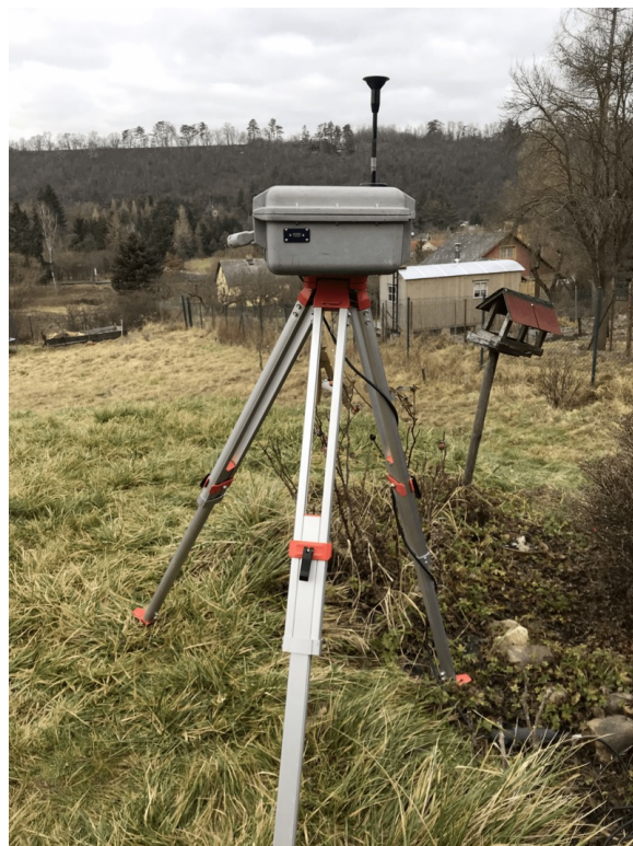
Obrázek 3.1: Umístění přístroje v Environmental Enclosure s odběrovou hlavicí na Stanici 7
