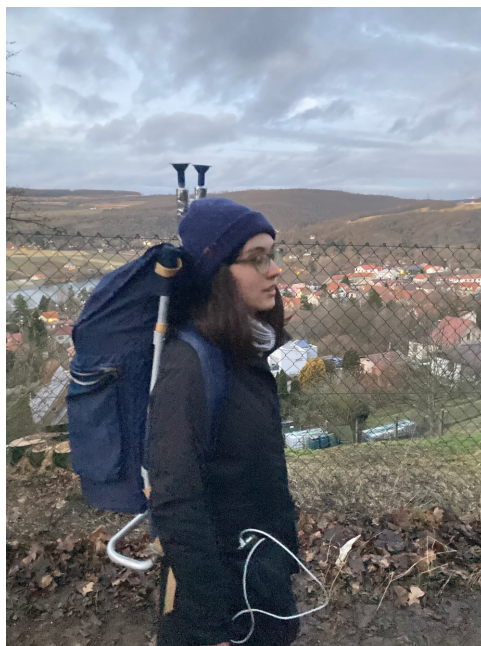
Obrázek 3.3: Batoh s DRX a P-Trak pro mobilní měření s odběrovými hlavicemi
