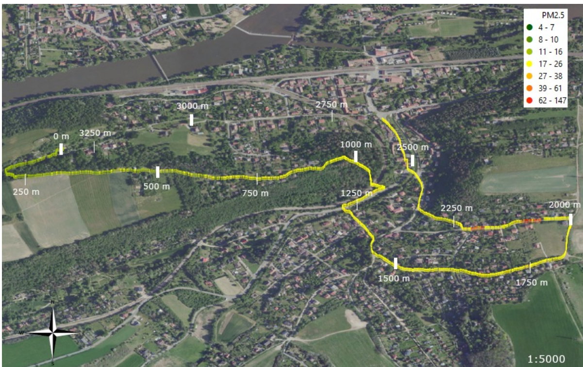
Obrázek A.2: Průběh koncentrace PM 2,5 v \mu\text{g} \cdot \text{m}^{-3} naměřené při Procházce 1
