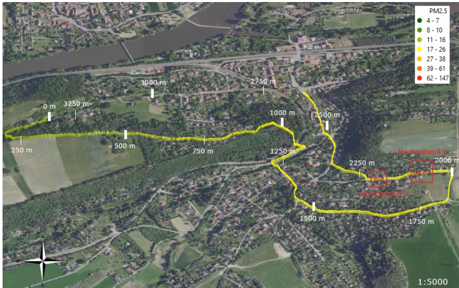
Obrázek 4.6: Průběh koncentrace \text{PM}_{2,5} v \mu\text{g} \cdot \text{m}^{-3} během procházky 1 s vyznačenými místy zvýšených koncentrací
