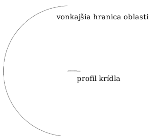
Obrázok 2: Ilustračný obrázok krivých hraníc výpočetnej oblasti profilu NACA0012
