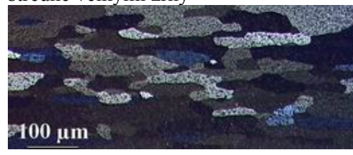
f) Z60, rekrystalizovaný materiál s malými zrný
