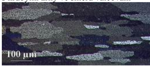
e) S60, rekrystalizovaný materiál s malými zrný
