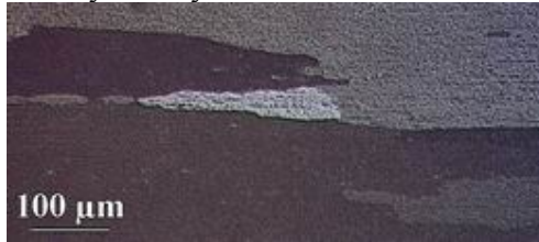
c) S40, rekrystalizovaný materiál s hrubými zrny ve směru válcování
