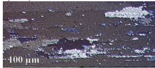
d) Z40, rekrystalizovaný materiál s různou velikostí zrn
