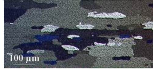
d) Z40, rekrystalizovaný materiál se středně velkými zrny
