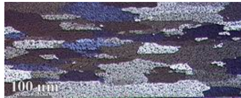
f) Z60, rekrystalizovaný materiál s malými zrna
