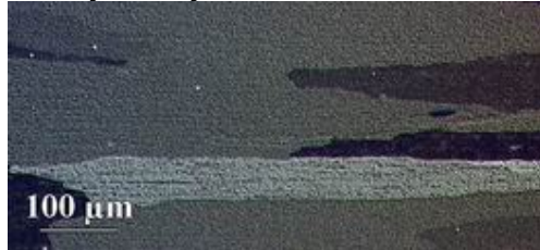
c) S40, rekrystalizovaný materiál s hrubými zrny ve směru válcování
