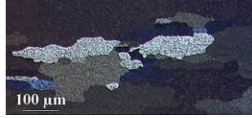
d) Z40, rekrystalizovaný materiál se středně velkými zrný
