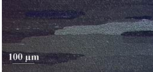
c) S40, rekrystalizovaný materiál s hrubými zrný ve směru válcování
