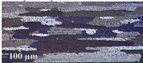
e) S60, rekrystalizovaný materiál s malými zrna
