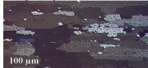
d) Z40, rekrystalizovaný materiál se středně velkými zrny
