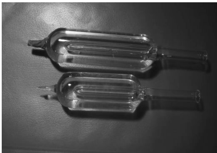
Obr. 8: Buňky použité při realizaci trojného bodu vody
