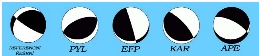
Obr. 5.15. Výsledky inverze zemětřesení Leonidio počítané vždy z jedné stanice. Shoda s referenčním řešením, získaným v této práci, je podle vztahu (2.15): PYL – 0.47, EFP – 0.55, KAR – 0.61, APE – 0.43.
