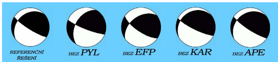
Obr. 5.13. Výsledky inverze zemětřesení Leonidio počítané vždy s vynecháním jedné stanice. Shoda s referenčním řešením, získaným v této práci, je podle vztahu (2.15): bez PYL – 0.16, bez EFP – 0.17, bez KAR – 0.07, bez APE – 0.03.
