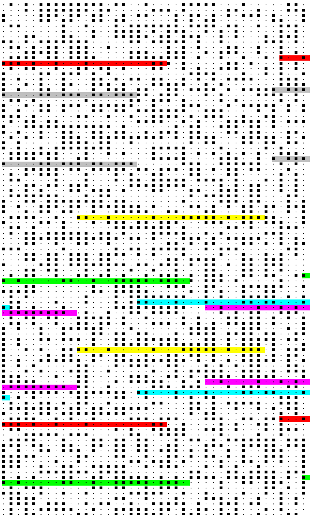
Obr. 3.3: První impuls klíče zprávy „ZMUG“ v délce 4000 znaků s barevně zvýrazněnými shodnými částmi vypsány do řádků o 41 znacích. Tečky odpovídají nulám, čtverečky jedničkám.
