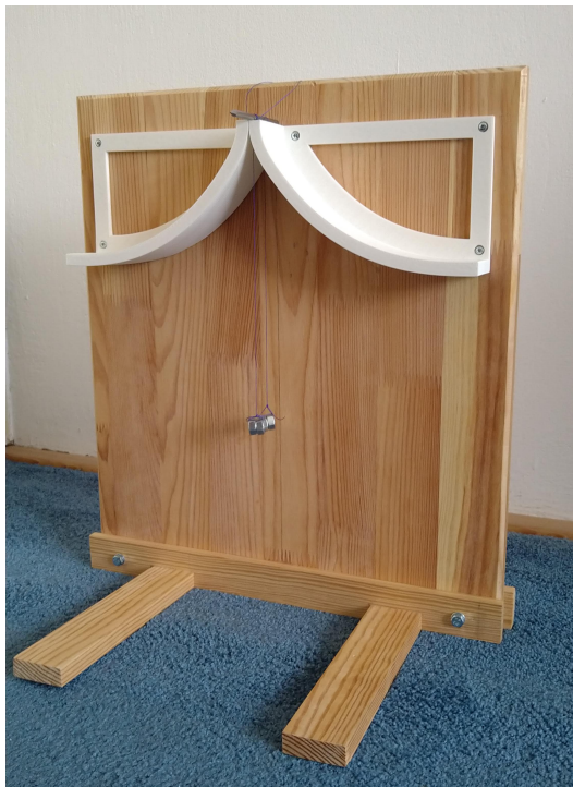
Obrázek 5.3: Model cykloidálního kyvadla se zarážkami ve tvaru cykloidy
