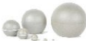
Obr. 12: pasivní markery ( www.qualisys.com )
