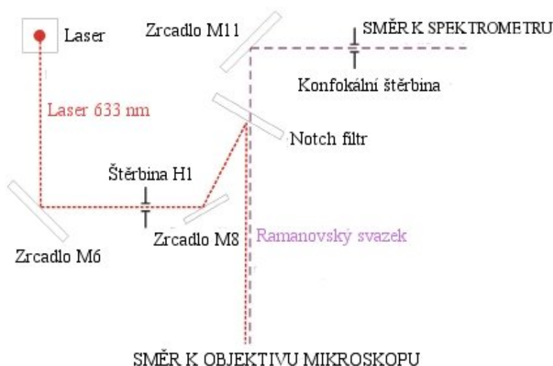
Obr. 19: Schéma integrovaného Ramanova systému HR 800 [47].
