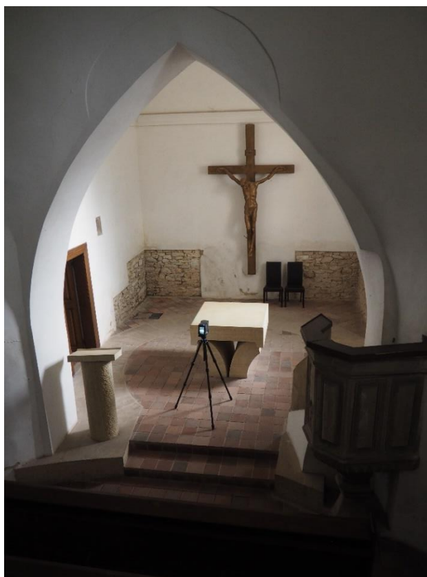
OBR. 10. Geodetická dokumentace rotundy sv. Petra a Pavla na Budči společností GEO-CZ, 3D scanování interiéru, 17. 7. 2020 (foto P. Tomanová).
