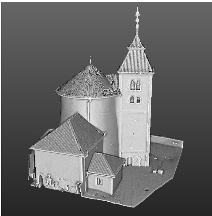
PLÁN 14. Náhled digitálního 3D modelu současné podoby rotundy sv. Petra a Pavla na Budči (zpracování: GEO-CZ).
