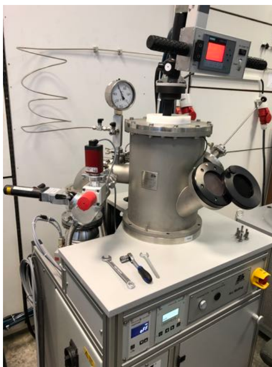
Obrázek 1.2: Vakuová pec AM200 od firmy Edmund Bühler
