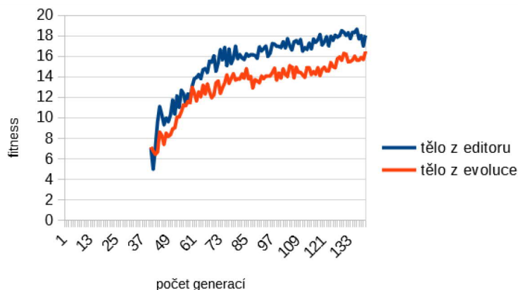
Obr. 19: Úspěšný tvar těla. Při dobrém návrhu těla byla evoluce mírně úspěšnější. Šlo o evoluci pohybu po rovině, 40 generací novelty search a 100 generací maximalizace fitness. Pro tělo z editoru se vyvíjela jen neuronová síť, proto byly zakázány všechny mutace těla kromě mutace limitů kloubů.
