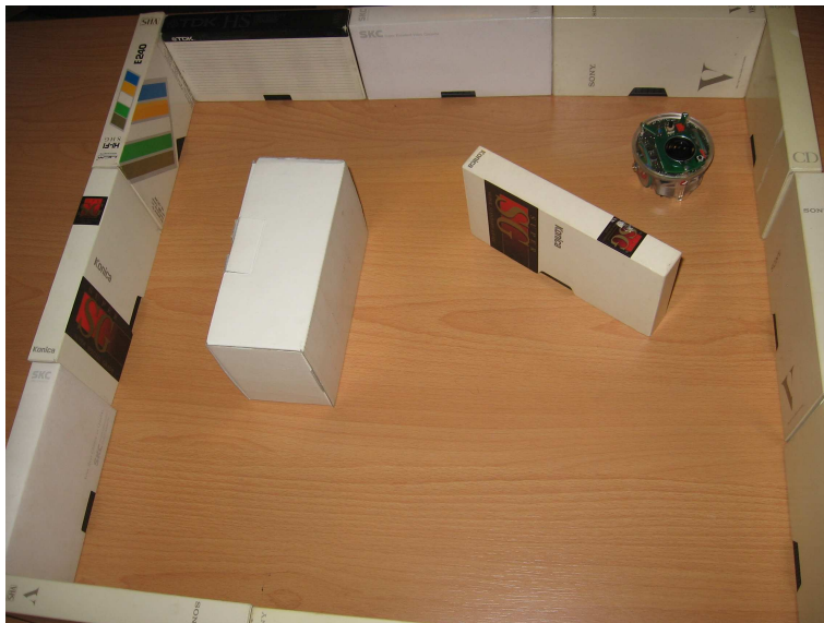
Obrázek 5.29: Experiment s fyzickým robotem e-puck - robot se pohybuje ve vymezeném prostoru, přičemž se úspěšně vyhýbá překážkám.
