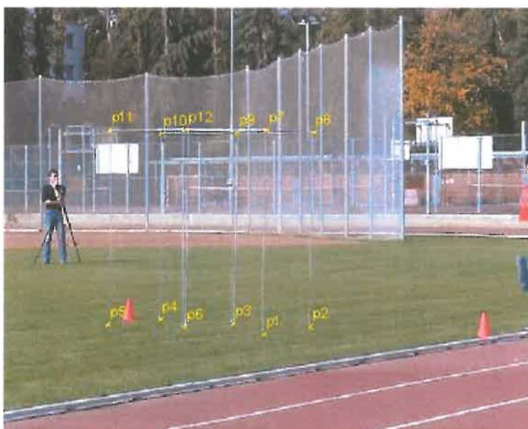
Obrázek 11 Zobrazení kalibrace pomocí dvou kalibračních krychlí pro3D analýzu (a)
