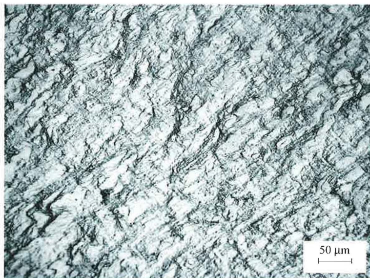
Obr. 26: Světelná mikroskopie - materiál deformovaný na 10 % plastické deformace při teplotě 673 K, \dot{\epsilon}_0 = 2 \cdot 10^{-2} \text{ s}^{-1}
