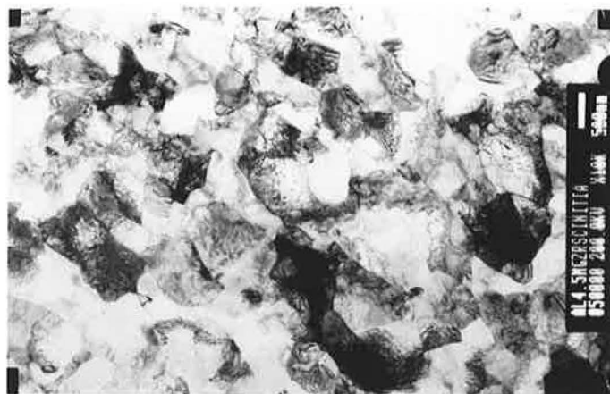
Obr. 50: TEM – materiál v základním stavu po protlačování ECAP
