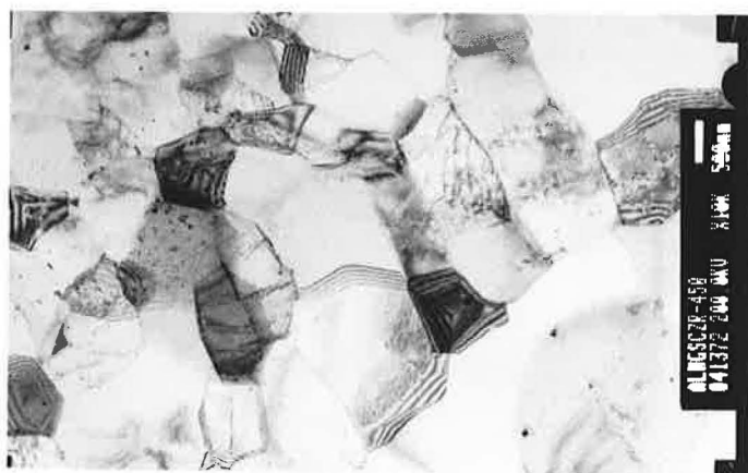
Obr. 54: TEM – materiál žíhaný 1 hod. při teplotě 723 K
