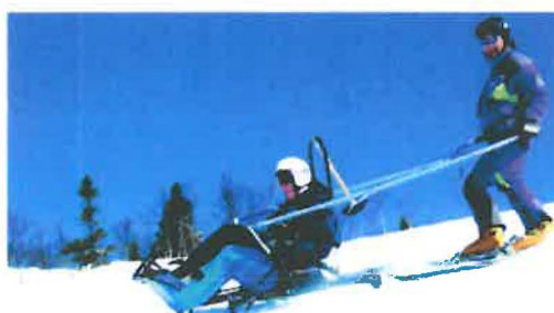
Obr. č.81 Ovládání a řízení skicartu doprovodnou osobou
