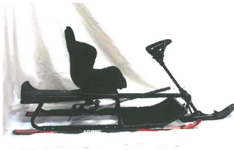
Obr. č.85 Boční pohled na Snowracer se speciální sedačkou a širokými podnožkami
