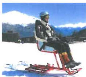
Obr. č.70 Pozice zvednutého sedáku u tandemski
