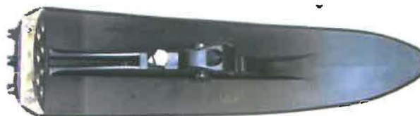
Obr. č.62 Pohled na tvar těla lyžičky stabilizátoru
