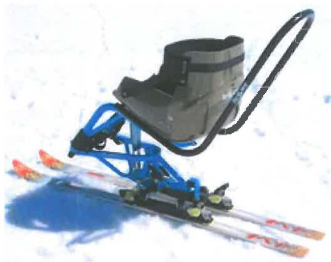
Obr. č.50 Dětská dualski a manipulační držadlo pro doprovod
