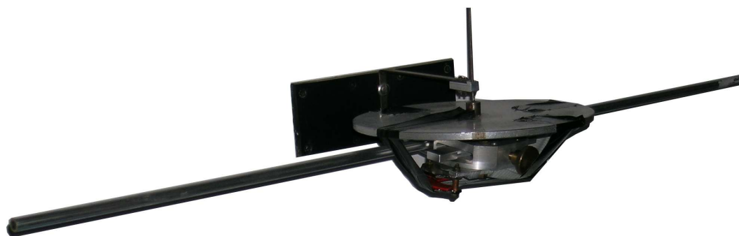
Obrázek C.2: Torzní kyvadlo užívané pro kalibraci měřicí aparatury v režimu krutu.
