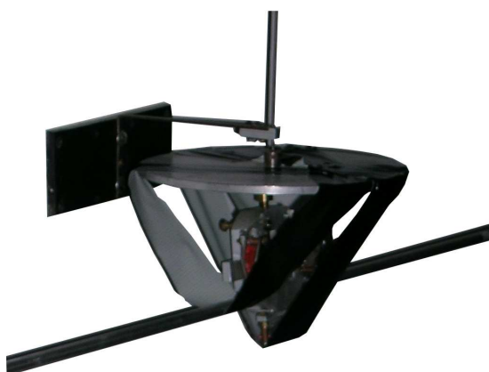
Obrázek C.3: Torzní kyvadlo užívané pro kalibraci měřicí aparatury v režimu ohybu.
