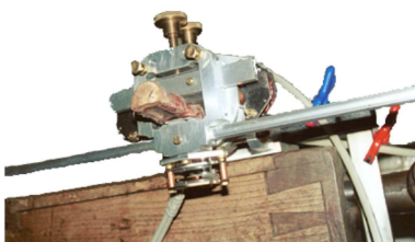
Obrázek 4.10: Celkový pohled na měřící aparaturu se vzorkem ovčí ploténky.
